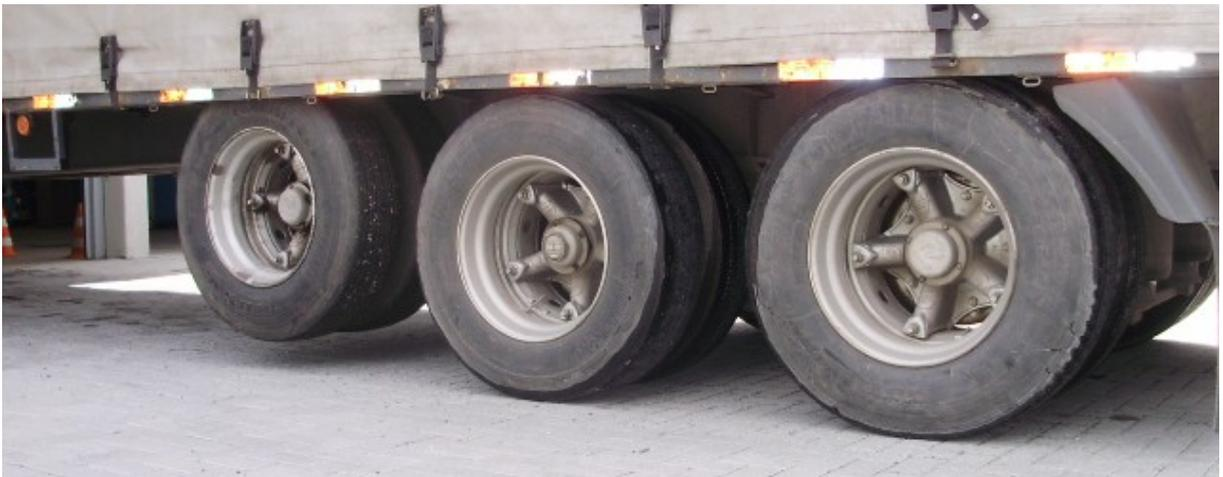
Figura 2: Tandem triplo com o 1º eixo levantado, tornando-o tandem duplo
